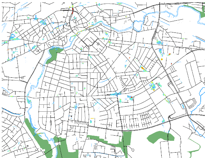
Figur D2: 1D-1D beregninger blev gennemført for regnvands- og fællessystemet for en meget stor fiktiv regnhændelse – en regnhændelse meget kraftigere end serviceniveauet kræver. Herover er vist et udsnit af resultatet.
