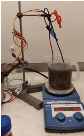
Figur 5: Forsøgsopstilling med batch elektrokoagulering af slam fra BlueKolding renselanlæg.
