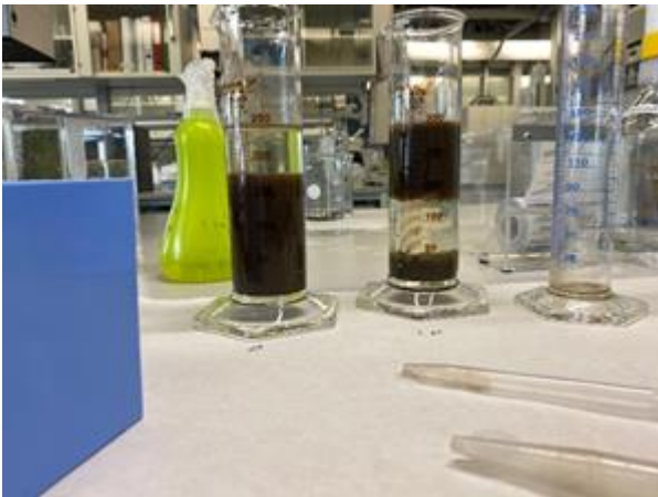
Figur 8: Prøver med slam, efter EC, hvor prøven til venstre viser dannelse af et svævende tæppe af slam.
