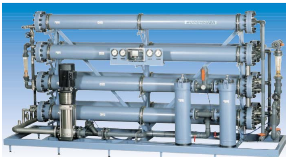
Figur 5-2 Omvendt osmose anlæg af fabrikat Silhorko, type 03-21. Anlægget er forsynet med to posetrykfiltre til forfiltrering samt 21 RO-moduler. Kapacitet: ca. 30 \text{m}^3/\text{h} (dog afhængig af fødevandet).
