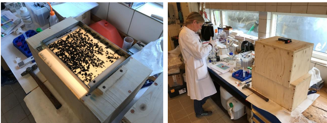
Figur 11. Den fjerde, og endelige, prototype. Venstre: Den nederste del, der indeholder to LED-liste, et hul dækket af dampspærre og beslag, der sikrer konsistent placering af beholderen til flokke. Højre: Den samlede opstilling med den øverste kasse, der holder kameraet.
