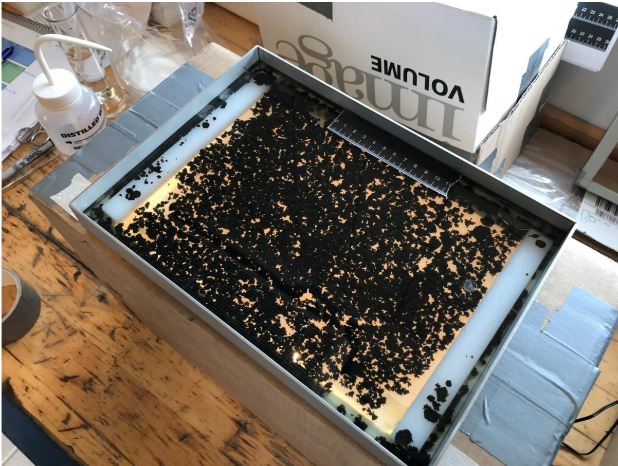
Figur 9. Prototype 3 designet til at opnå en flad udsprejning af flokke. Beholderen står på en kasse med to LED-lister i bunden og et hul i toppen, der er dækket af almindeligt printerpapir. Kameralinsen placeres i et hul i en anden papkasse (den hvide i baggrunden) som derefter placeredes oven på metalrammen for at blokere eksternt lys.
