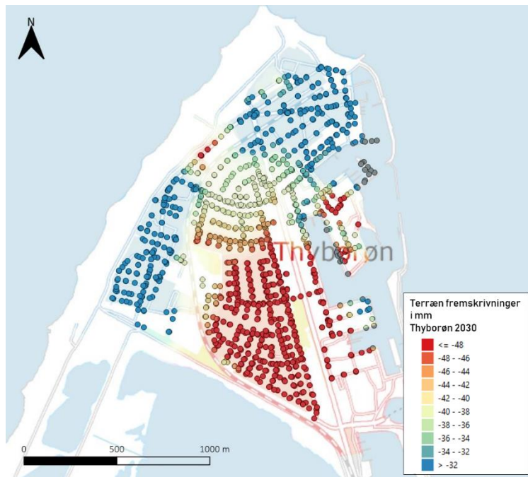
Step 25.1 Fremskrivninger af målte terrænændringer i Thybrøn, her vist for år 2030. Kortet viser at der er områder der har undergået terrænsætninger på mere end 48cm regnet fra den nuværende tilstand.
