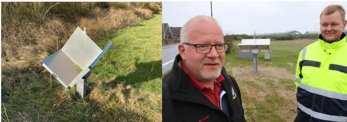
Figur 4 Hjørnereflektor opsat på et stabilt fundament, kan anvendes som kendt, specifikt reflektorpunkt i et område. Dette kan hjælpe til kalibrering af data, samt øge nøjagtigheden af datagrundlaget for landbevægelsesberegningerne. Foto tv: LVS, Foto th: Benny Gade.
