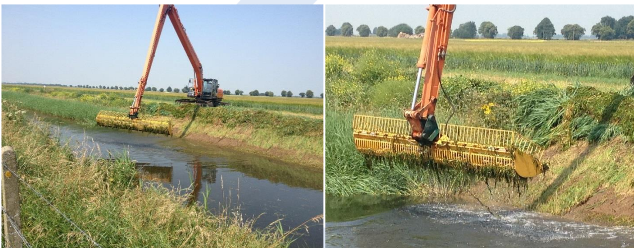
Figur 5-11 Maskine monteret på mejekurv på lang arm
