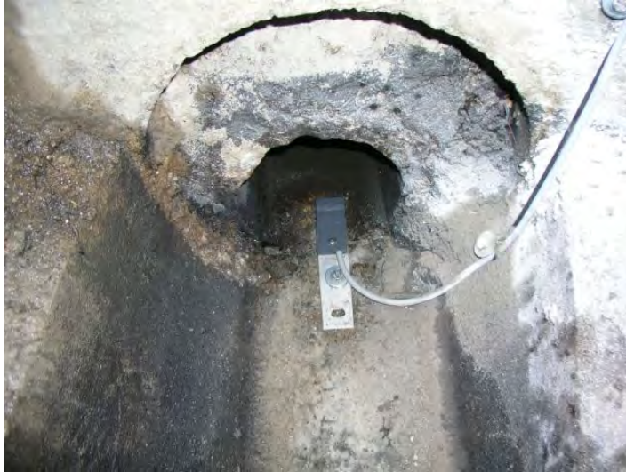
Figur F.2 Hastigheds- og niveau måler placeres i regnvandsledning og vandføringen beregnes.
