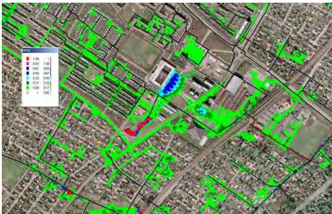
Figur D.7 Maksimale oversvømmelsesdybder beregnet for en 10 års CDS regn, fremskrevet med 100 år. Regninput: 10 års CDS regn og vandstand i Køge Bugt fremskrevet for klimascenarium A2.
