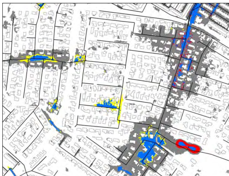
Figur 4.23 Sammenligning mellem resultater af hulkort (grå), hydraulisk overfladeberegning (rød) og kombineret hydrodynamisk afløbsmodel og overflademodel 1D-1D (gul). Blå er sammenfald mellem hydraulisk overfladeberegning og kombineret hydrodynamisk afløbsmodel og overflademodel.
