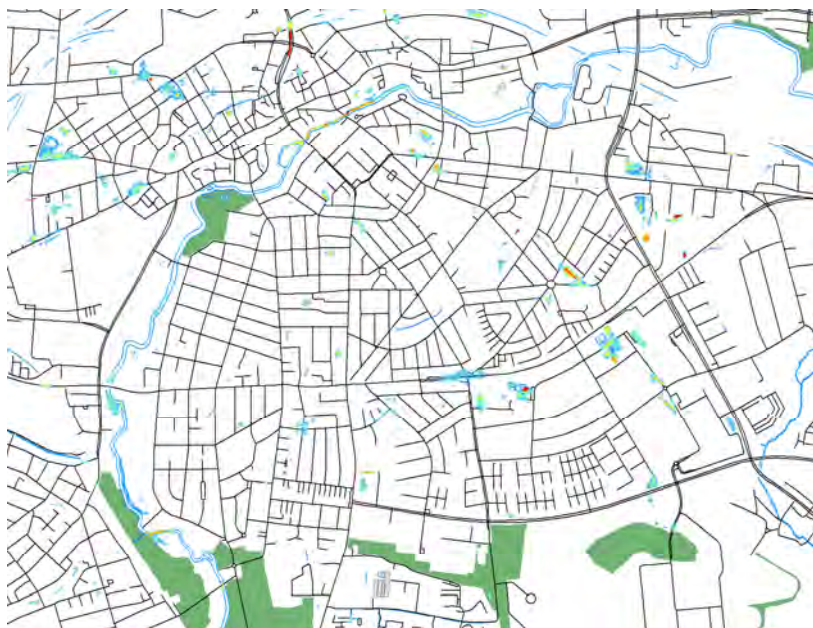
Figur G.2 1D-1D beregninger blev gennemført for regnvands og fællessystemet for en meget stor fiktiv regnhændelse – en regnhændelse meget kraftigere end serviceniveauet kræver. Herover er vist et udsnit af resultatet.
