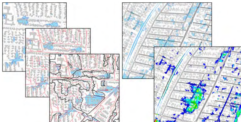
Figur 4.22 Terrænmodeller og hulkort giver en god oversigt over potentielle oversvømmelser og strømningsveje på overfladen.
