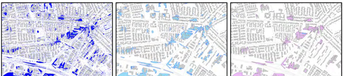
Figur 4.3 Reduktion i antallet af lavninger ud fra volumen. Første del viser alle lavninger, anden del lavning over 100 m 3 og tredje del viser lavninger over 500 m 3 .
