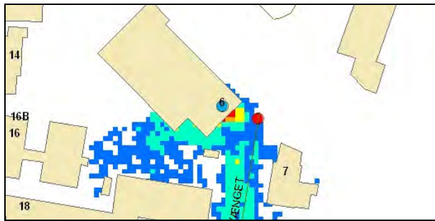
Figur G.9 Ingen grøft langs banelegeme. Lille "gryde" foran vinduesparti. DTM data synes at beskrive terrænet korrekt.
