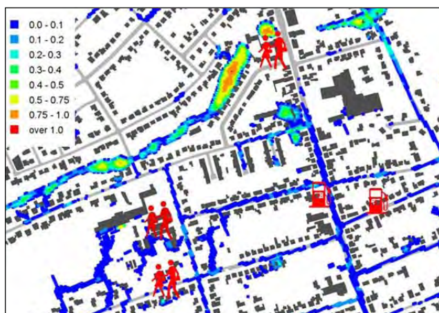
Figur 6.7 Eksempel på GIS-tema over særlige bygninger. Oversvømmelsens niveau er afbilledet sammen med placering af skoler og børnehaver samt tankstationer.
