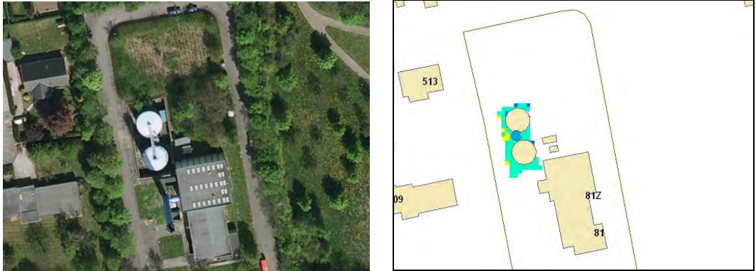
Figur G.3 Det virker ikke logisk, at siloer, der er beliggende i en fordybning, ikke er beskyttet af en kant.
