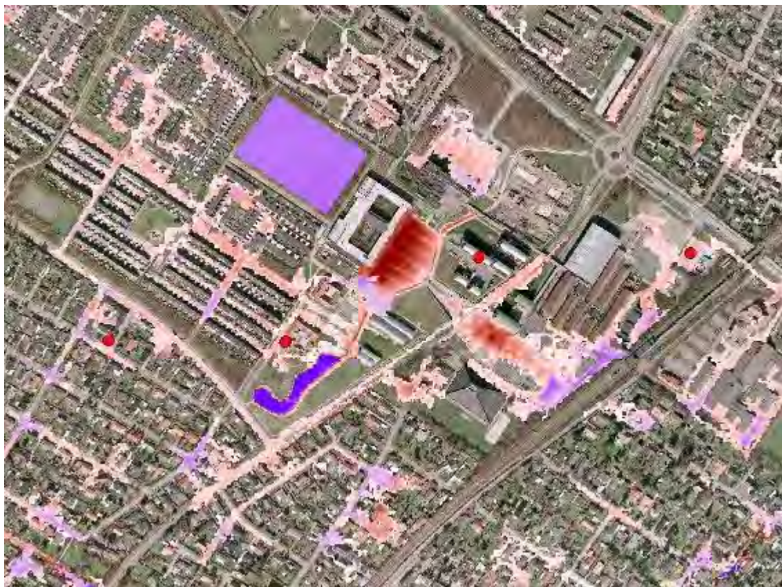
Figur D.10 Blå/lilla farve indikerer oversvømmelser efter installation af to 0,5 \text{ m}^3/\text{s} pumper og anvendelse af fodboldbanen som regnvandsbassin. Røde farver viser omfanget af oversvømmelser før installation af de to pumper. Regninput: 10 års CDS regn og vandstand i Køge Bugt fremskrevet for klimascenarium A2.
