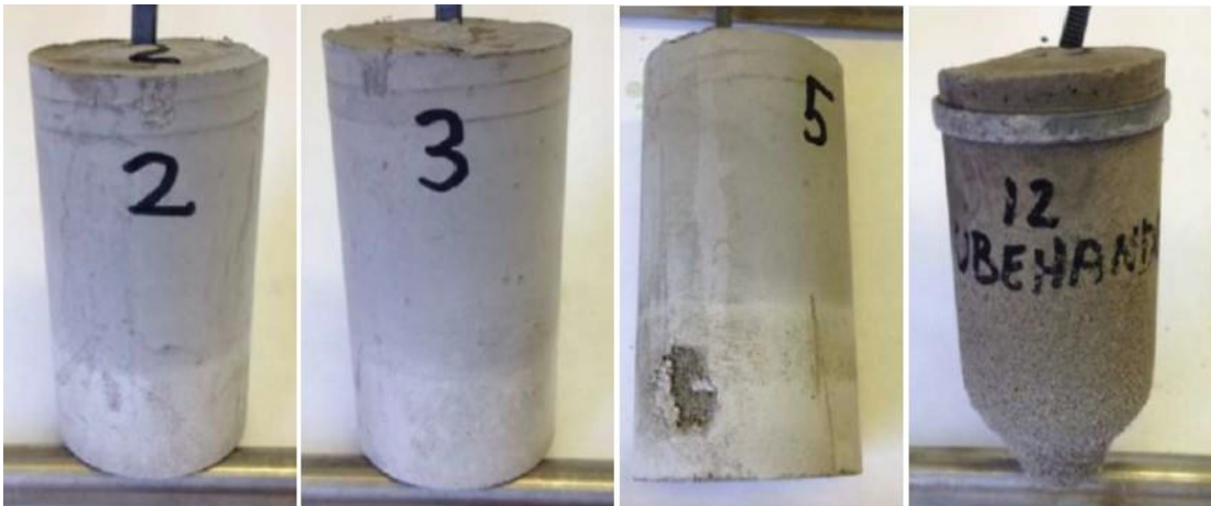
Fig. 2 Resultat af accelererede korrosionstests med forskellige behandlinger (2 og 3: Nedsænket 4 gange i forskellige typer vandglas; 5 sprøjtebehandlet med samme type vandglas som 2; 12: ubehandlet).
