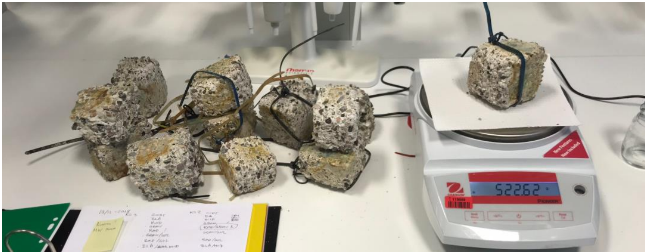
Fig. 23 Kontrolvejning af betonelementer efter fjernelse af korrosionsprodukter og tørring.
