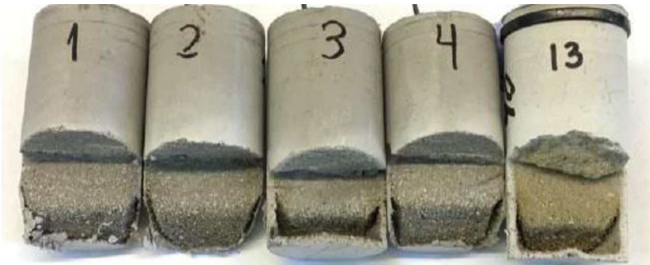
Fig. 3 Vurdering af coatingens indtrængningsdybde ud fra syrepåvirkning af ubehandlede områder.
