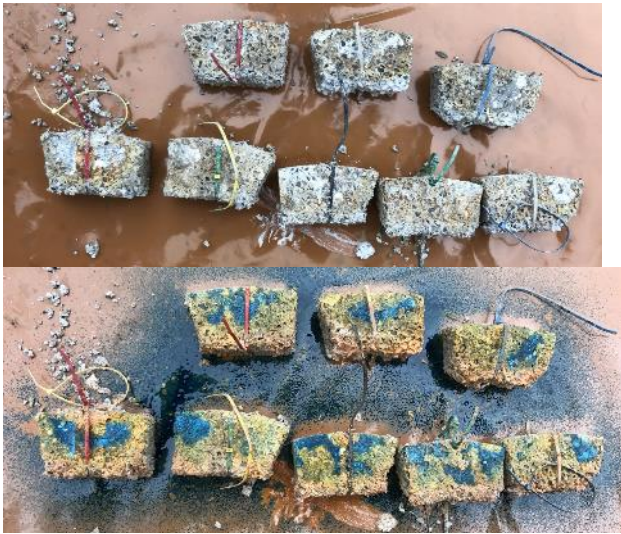
Fig. 22 Korroderende betonelementer før (t.v.) og efter (t.h.) påføring af pH-indikator.
